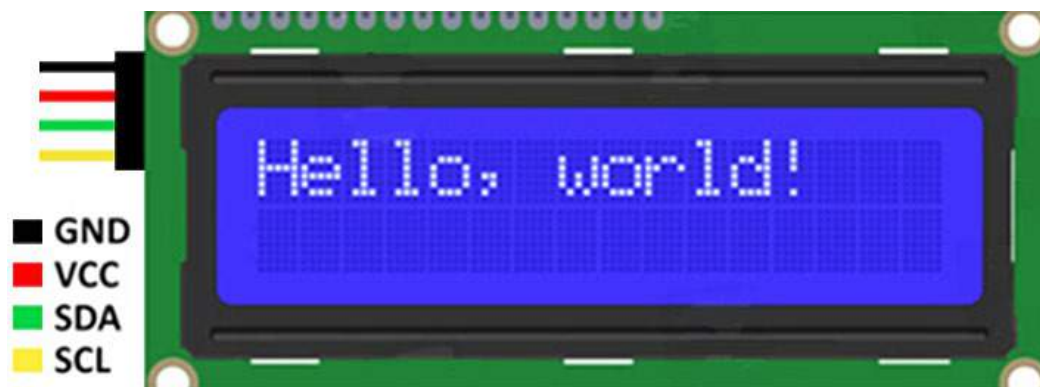
Рис. 1. Подключение модуля ЖКИ к Ардуино
